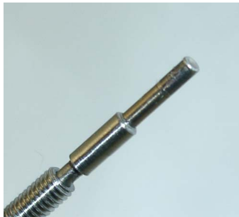
Miniaturdrucksensor Ø 1,5 mm
