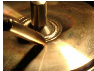
Laserschweißen von Sonderwerkstoffen (Titan, Hastelloy, Inconel, ...)
